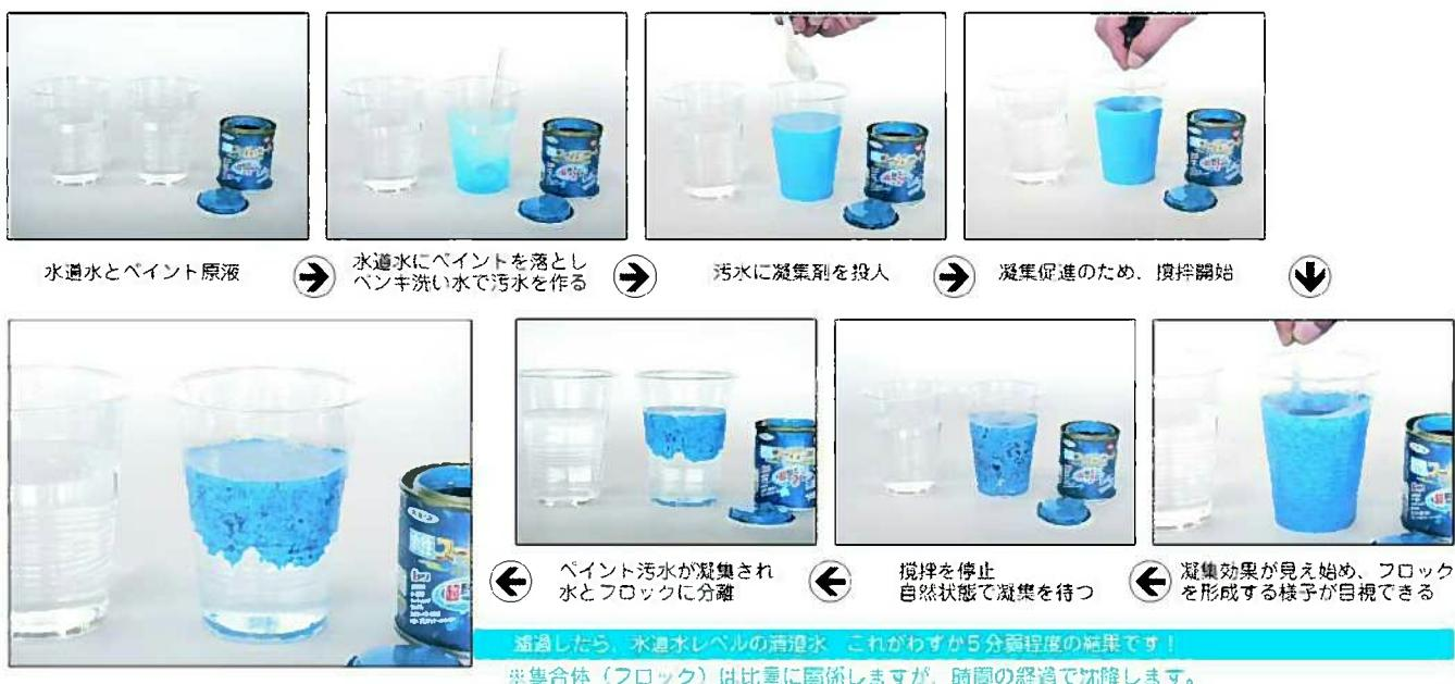
※アラゴフロックは、土木工事汚泥水処理等でも汚濁水 1 m<sup>3</sup> (1トン) 当り目安的には 50g ~ 150g 程度の投入量で、放流水質基準値内処理が可能です。(汚濁水濃度により投入量は異なります。)
